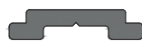
SA 33 Perfil complementar (Anodizado com >20 microns) Complementary profile | Profilé complémentaire (Anodised with >20microns | Anodisé avec >20 microns)
